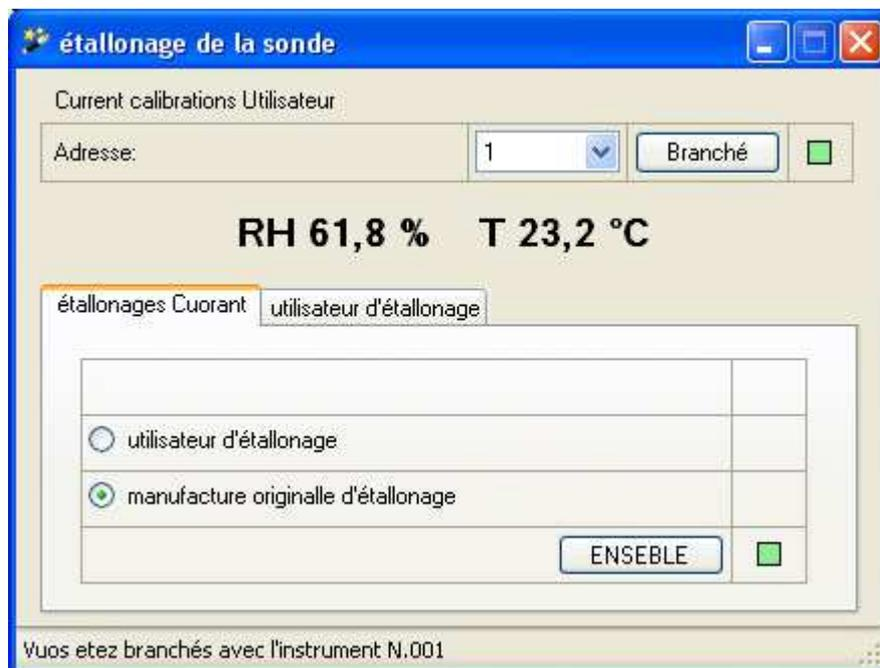
La section «étalonnage en utilisation »permet de passer du étalonnage d'usine (étalonnages originaux d'usine) au étalonnage utilisateur (« étalonnages utilisateur»).
