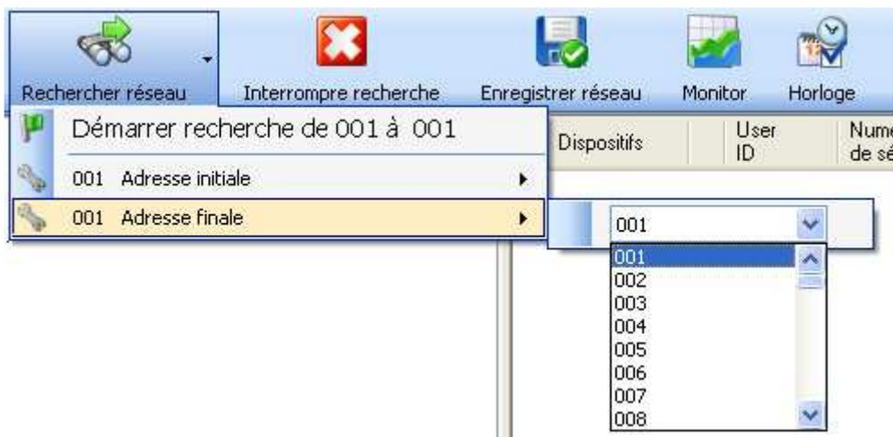
11. Cliquer sur le bouton "Lancer recherche de ... à ..." pour démarrer la connexion des instruments.
