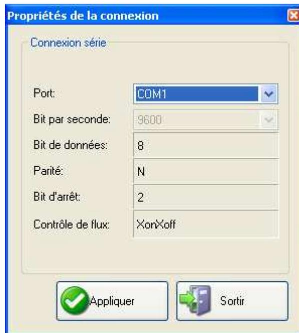
4. Sélectionner le port COM auquel l'instrument est connecté. Les autres paramètres de la connexion sont fixes et ne peuvent pas être modifiés.
