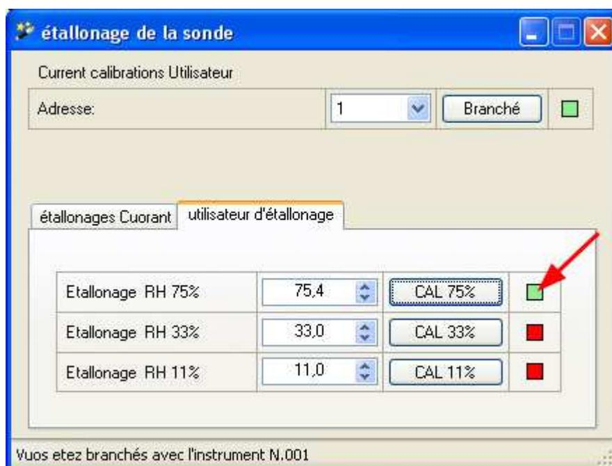
15. Si necessaire, répéter la même procédure pour étalonner les autres points.
