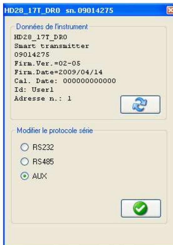
15. La sélection courante est sur "AUX": sélectionner le protocole de communication qui sera utilisé par l'instrument lors de son fonctionnement définitif:
