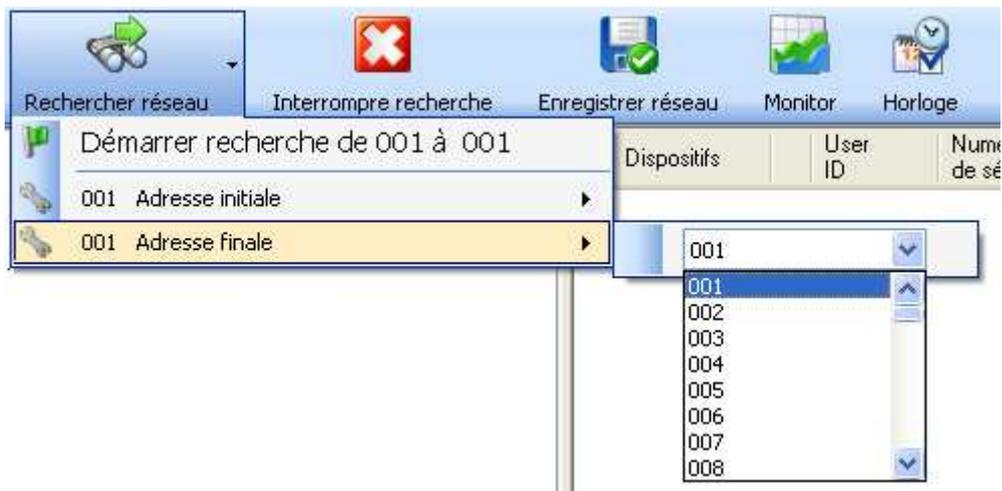
**15.** Cliquer sur le bouton "Lancer recherche de ... à ..." pour démarrer la connexion des instruments.
